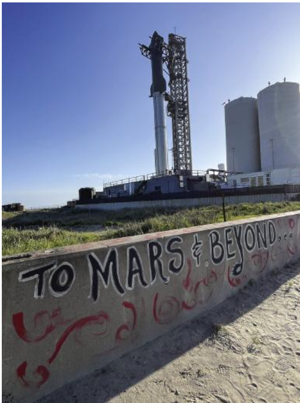
Рис. 2. Ракета Starship компании SpaceX на стартовой площадке Starbase перед первым испытательным запуском в апреле 2023 года. И верхняя ступень, и ускоритель Super Heavy задуманы многоразовыми, чтобы удешевить доставку людей и грузов в дальний космос. Вместе ускоритель и вторая ступень составили самую большую ракету из когда-либо построенных. Источник: Scott Solomon
