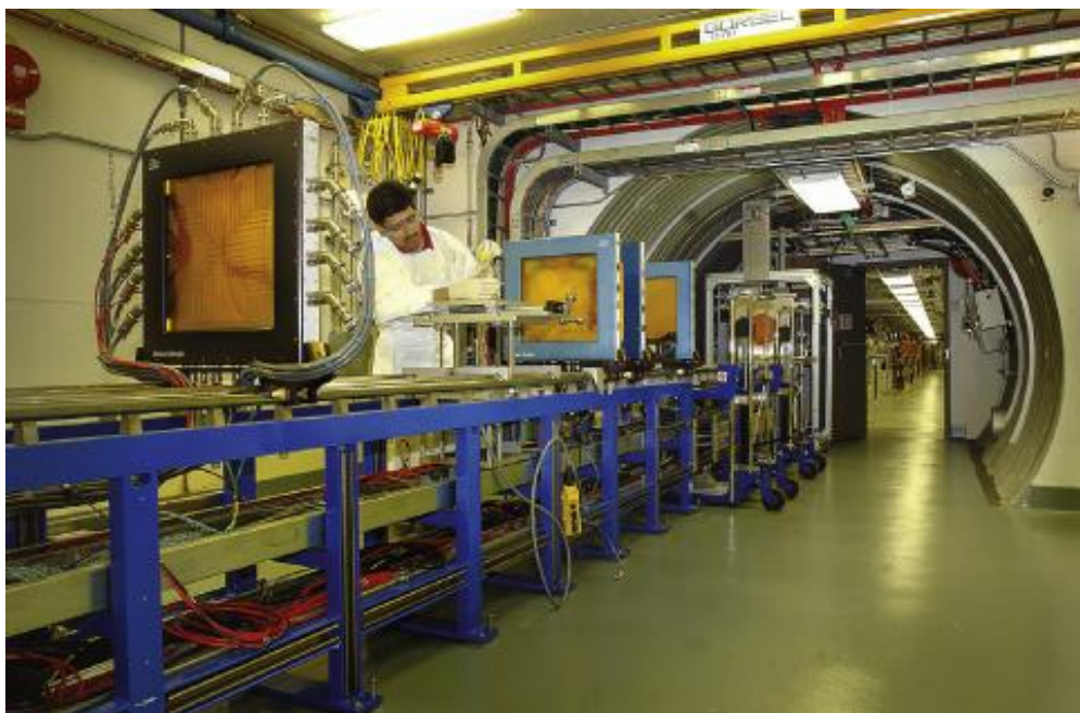
Рис. 14. Исследовательница готовит образец в мишенном зале Лаборатории космической радиации НАСА. В лаборатории, расположенной в Брукхейвенской национальной лаборатории, есть симулятор галактических космических лучей, с помощью которого изучают влияние космической радиации на тело и разум. Источник: NASA
