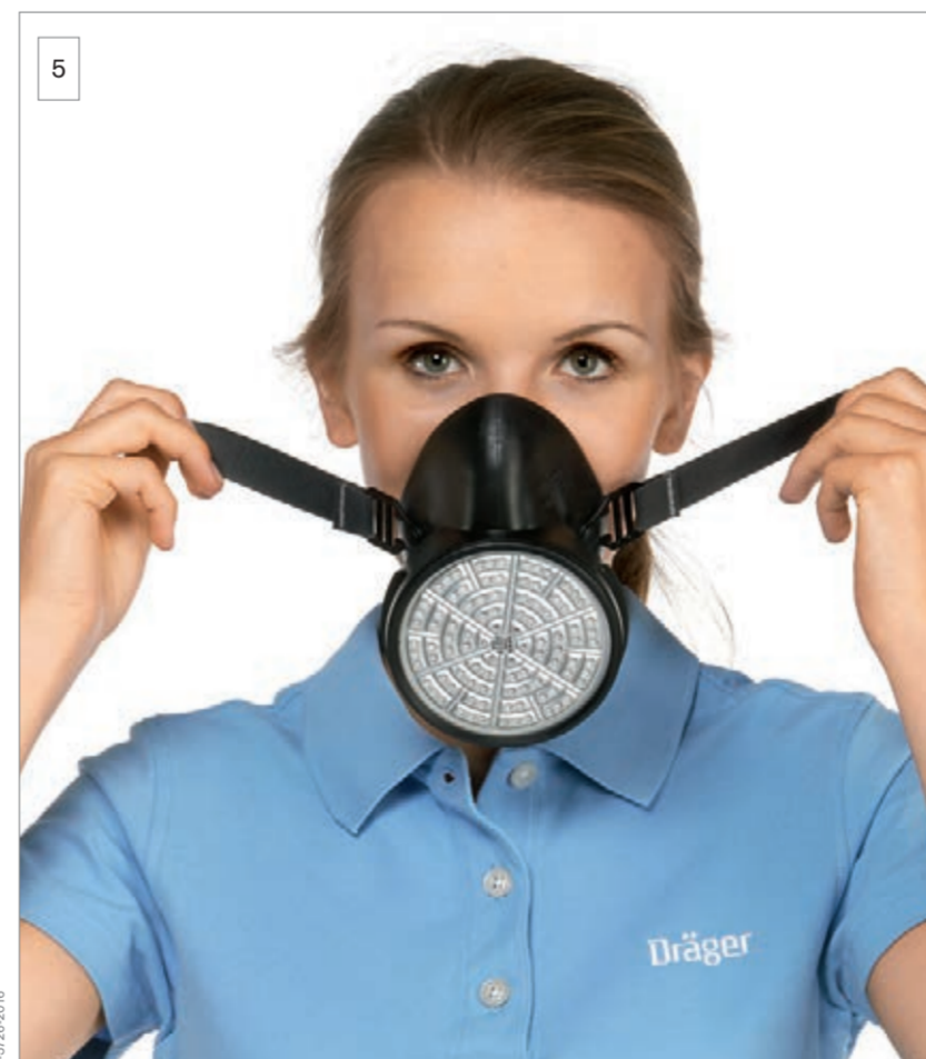
5 Fassen Sie die Halbmaske an den Bändern, halten Sie sie vor Mund und Nase, so dass Ihr Kinn in der Kinnmulde liegt.
