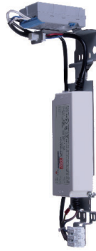
LED-Betriebsgeräteträger (BT) inklusive Befestigungsmaterial (4x Distanzbohlen (DH) Max45mm, 2xDistanzhülsen (DH) 4mm hoch, DM 8mm, für Leuchte CAMPO „7700“ zusätzlich 4 x Distanzbohlen Max20mm zur Verlängerung der Distanzbohlen M4x45 auf 65mm 6x Gewinndschrauben (S1) (S2) M4x16mm, 3x Zahnschraube 4,3mm )
