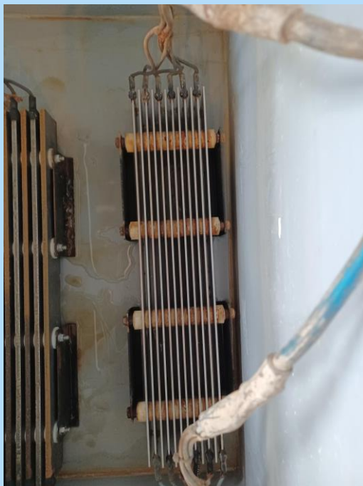
Elektrode od nehrđajućeg čelika
