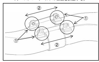
エキゾーストマニホールドをシリンダーヘッドに 仮止めし、マニホールドがうまく合わない場合は、 マニホールドの中間差し込み部分で調整する。
