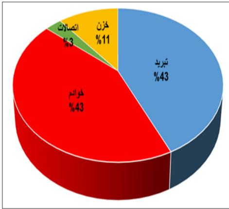
الشكل رقم (٢) نسب استهلاك الطاقة الكهربائية لمكونات مراكز البيانات في الولايات المتحدة الامريكية
