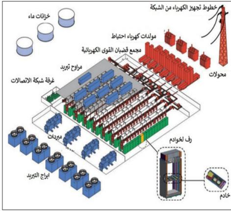
الشكل رقم (١) مكونات مراكز البيانات الأساسية و مصادر الطاقة الكهربائية الخاصة بها.
