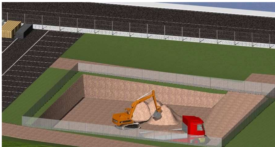
Figura 5. Area di scavo con opere provvisionali
