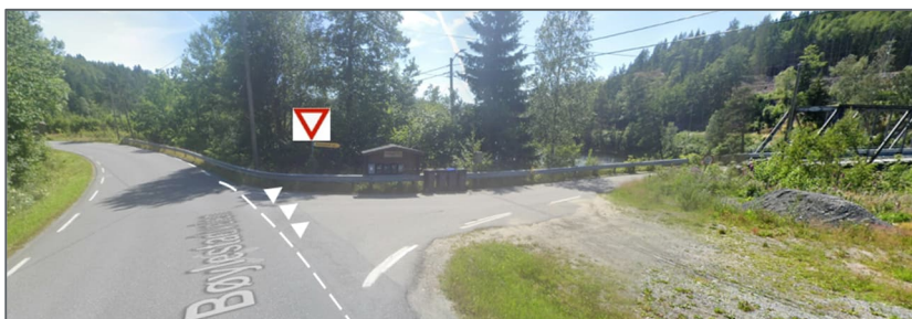
Figur 4-10: Prinsipp for vikepliktsregulering av Bøylestad bru. (Bilde: Google Maps street view, juli 2025)
