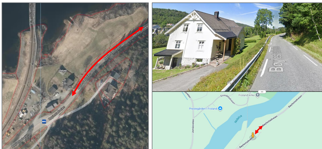
Figur 3-13: Smal kjørebane uten møteplass og dårlig sikt i kurve. I denne kurven har det skjedd en politirapportert trafikulykke over den siste tiårsperioden.
