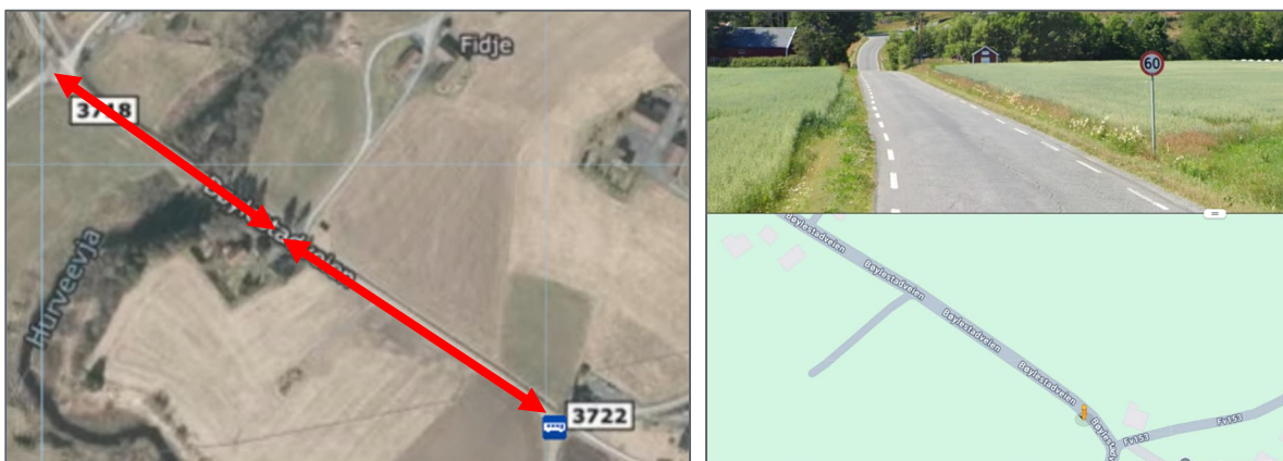
Figur 3-11: Strekning uten møteplasser, men det er avkjørsler og kryss som i praksis vil benyttes som møteplasser. Ikke sikt mellom disse to avkjørslene på grunn av horisontalkurvatur og vertikalkurvatur (lavbrekk). (Flyfoto: Finn kart. Gatebilde: Google Maps Street View, juli 2025)
