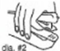
2. Levante la placa de sujeción sin hacer hacia abajo el brazo de la aguja. Coloque la tela debajo de la placa de sujeción. (Diag.#2).
