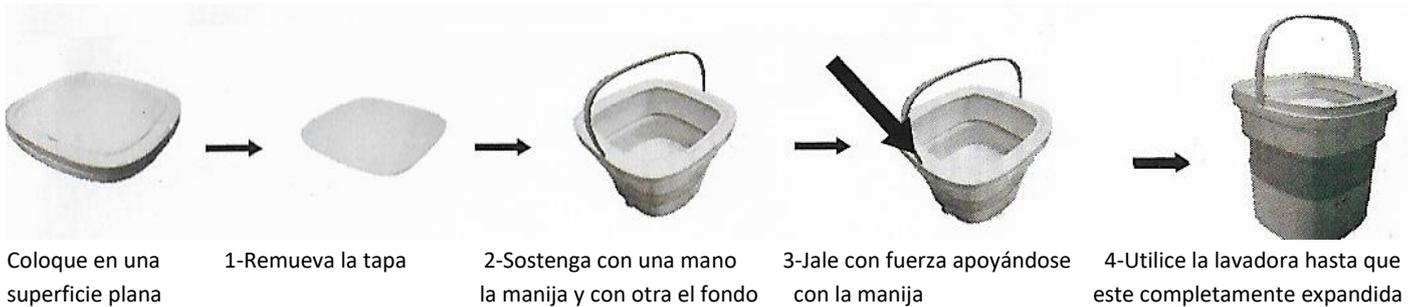
Para guardar (colapsar o "cerrar") la lavadora, con ambas manos a cada lado del marco de la lavadora, empuje al mismo tiempo hacia abajo. Una vez totalmente colapsada, coloque de nuevo la tapa.
