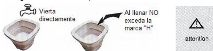
\*NO utilice agua a temperatura mayor a 60°C ya que las altas temperaturas pueden llegar a deformar las partes plásticas de la lavadora.
