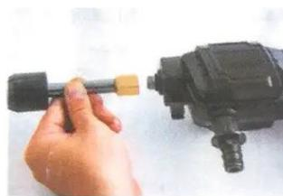
Inserte la válvula de presión que desea utilizar (la color rojo de alta presión o la color blanco en forma de abanico):
