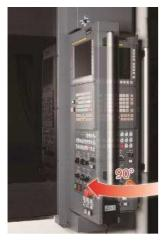
Le pupitre opérateur est inclinable à 90° pour faciliter l'exploitation de la machine, notamment en mode réglage
