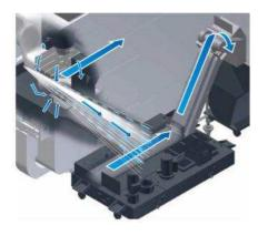
Les copeaux quittent immédiatement la zone d'usinage par le côté de la machine (sans la traverser)
