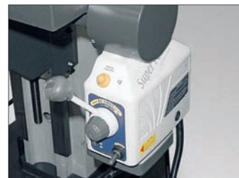
Code 40026 Power: Avance automatique longitudinale mécanique de la table
