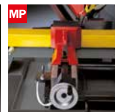
Morsa pneumatica Pneumatic vice
