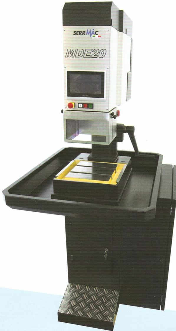
FORATRICE E MASCHIATRICE A CONTROLLO NUMERICO - MASCHIATURA RIGIDA
