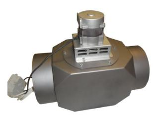
Die Montage des Ventilators auf den Schornsteinstutzen erfolgt so, dass sich die Achse des Ventilatormotors in horizontaler Lage befindet. Motorachse darf nicht senkrecht stehen. Die Enden des elektrischen Leiters werden an einem Schalter angeschlossen. Nach Drücken des Schalters wird der Abzugsventilator in Betrieb gesetzt. Während des Betriebs Abzugsventilators kann der des Brennstoff nachgefüllt werden. Nach dem nachfüllen erneut den Schalter und das Abgasgebläse drücken schaltet wieder ab
