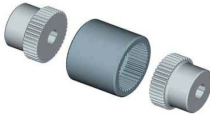
Şekil 1. Örnek bir üç parçalı elastik kaplin
