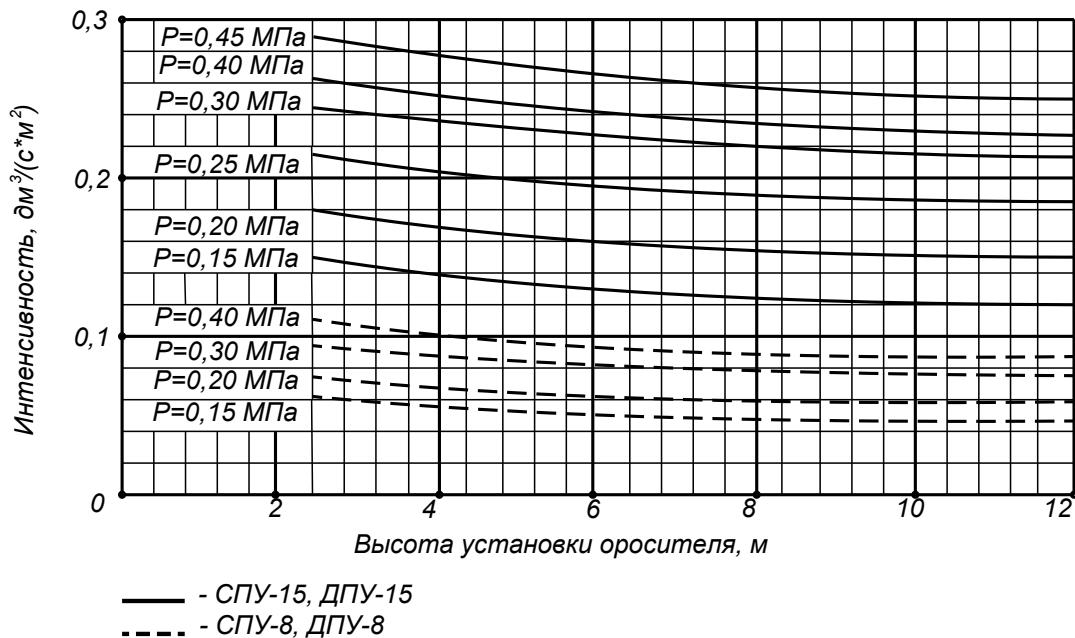
4.2 Графики зависимости средней интенсивности орошения от давления на защищаемой площади  $12 \text{ м}^2$  при высоте установки оросителей 2,5 м
