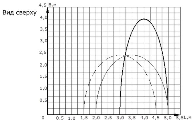
**Эпюры орошения оросителя центробежного «ОЦ-12» на защищаемой площади 9м<sup>2</sup> на воде и 7 м<sup>2</sup> на пене (тонкими линиями указаны эпюры орошения для всей орошаемой площади)**
