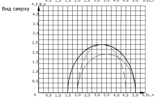
**Эпюры орошения оросителя центробежного «ОЦ-9» на защищаемой площади 12м<sup>2</sup> на воде и 7 м<sup>2</sup> на пене (тонкими линиями указаны эпюры орошения для всей орошаемой площади)**
