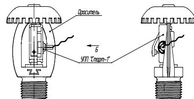
Схема установки УПП «Старт-1» (исполнение 3) на распылитель типа «РВД»
