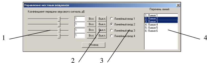
Рисунок 7.29. Диалоговое окно установки управления местным вещанием. 1 – органы управления громкостью, 2 – кнопки включения/выключения входов МВ, 3 – кнопки выбора входа для задания линий оповещения, 4 – список линий оповещения.
