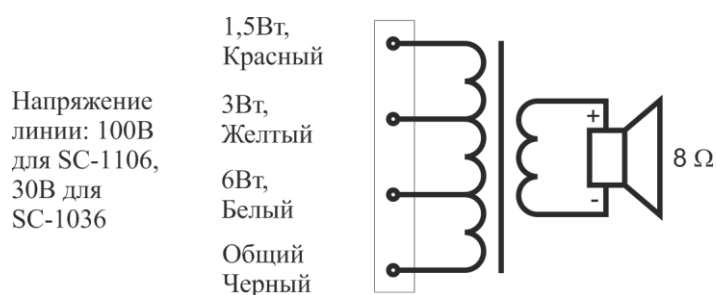
Рис. 2. Схема подключения громкоговорителя.
