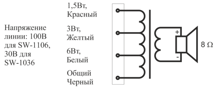
Рис. 2. Схема подключения громкоговорителя.
