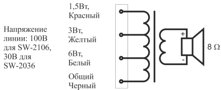
Рис. 2. Схема подключения громкоговорителя.
