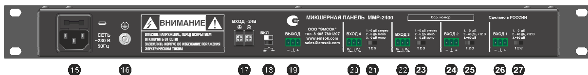
Рис. 2. Задняя панель МП. 15 – соединитель и предохранитель питания ~230В, 16 – клемма защитного заземления, 17 – клеммная колодка питания =24В, 18 – выключатель заземления, 19 – соединитель выхода, 21, 23, 25, 27 – микропереключатели уровня 4, 3, 2, 1 входа, 20, 22, 24, 26 – соединители 4, 3, 2, 1 входа.
