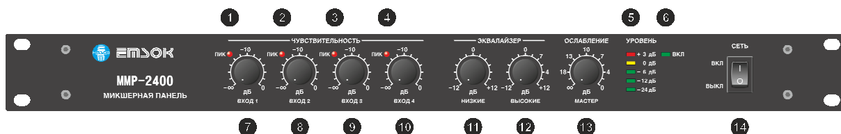
Рис. 1. Передняя панель МП. 1, 2, 3, 4 – индикаторы пикового уровня сигнала, 5 – индикатор уровня выходного сигнала, 6 – индикатор включения, 7, 8, 9, 10 – регуляторы уровня сигнала входов, 11 – регулятор уровня низких частот, 12 – регулятор уровня высоких частот, 13 – регулятор уровня выходного сигнала, 14 – выключатель питания.
