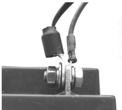
6. Подключить сетевые провода к входному клеммнику ЦПИУ «Орион» (**фаза (L)** должна быть подключена к **ХТ1.1:2**, см. приложение Б);
