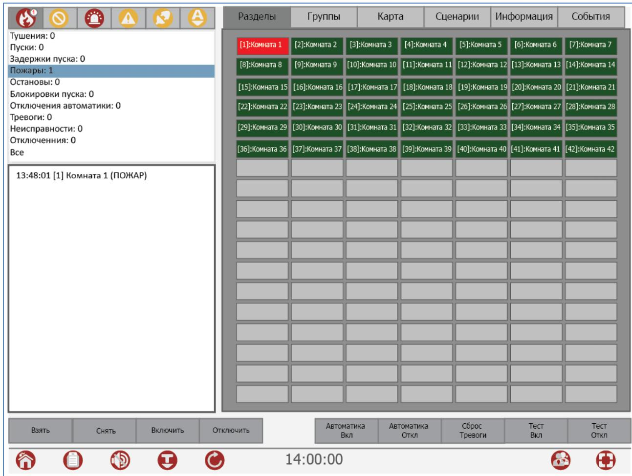
**Рисунок 52.** Отображение режима "Пожар" на дисплее пульта
