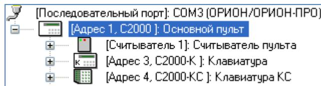
Рисунок 29. Добавление устройств по протоколу "Орион Про"
