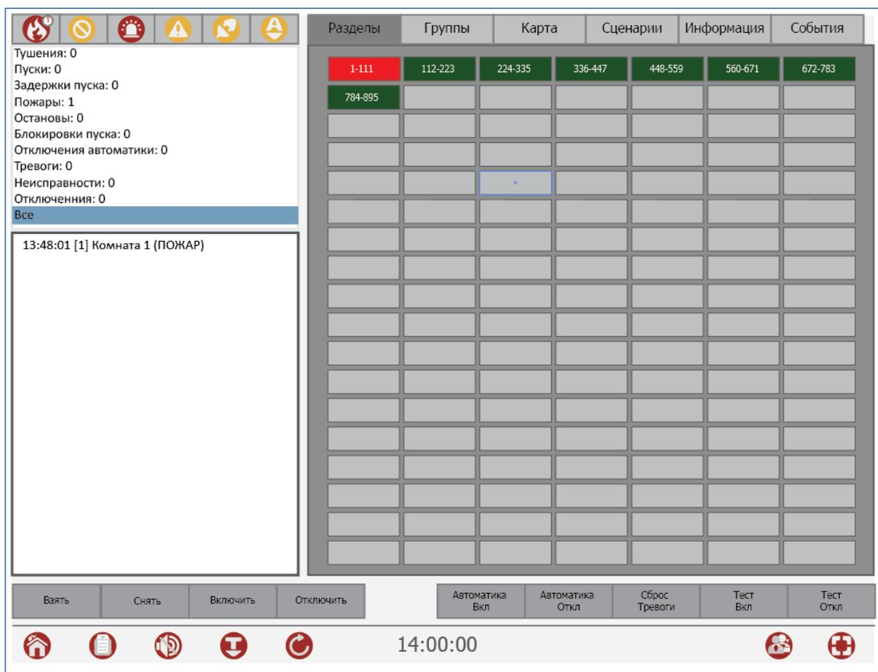
Рисунок 11. Вид экрана при группировке разделов в интервалы
