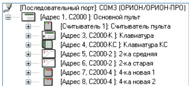
Рисунок 26. Дерево объектов протокола "Орион Про"
