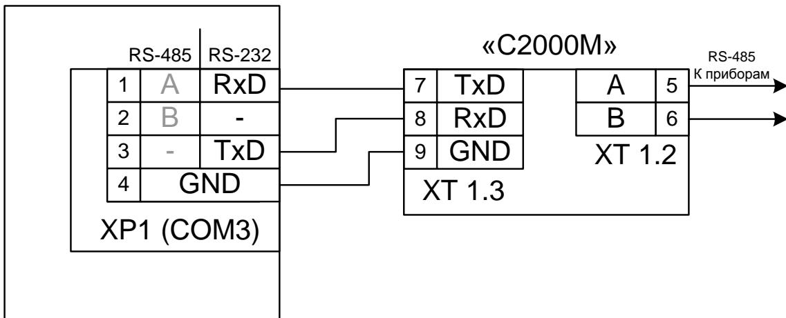
**Рисунок 46.** Простейшая схема подключения пульта "C2000M" к ЦПИУ "Орион" по RS-232 интерфейсу
