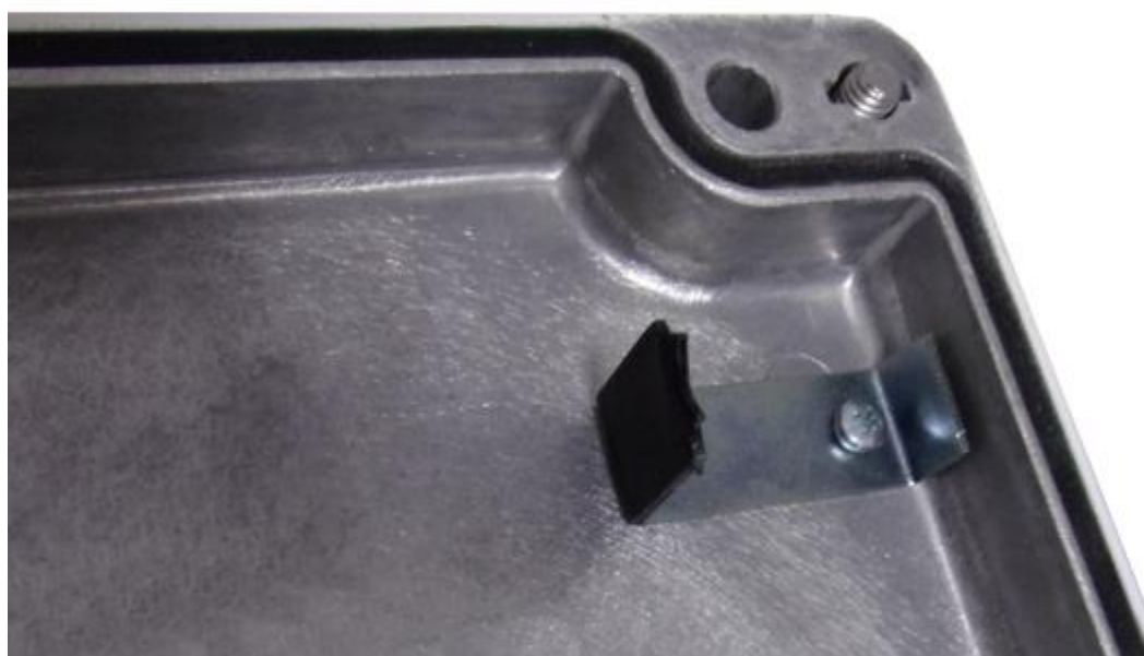
Рисунок 3.5.2 - Шторка датчика вскрытия на крышке блока
