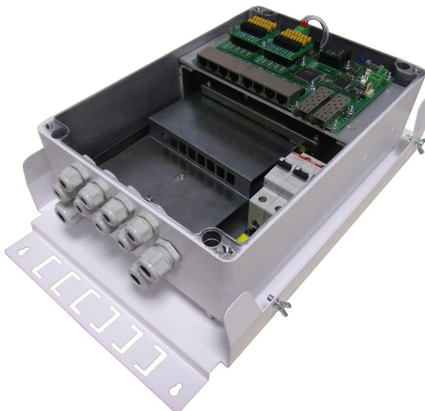
Рисунок 3.1.2 - PSW-2G8F+Hot - вид внутри
