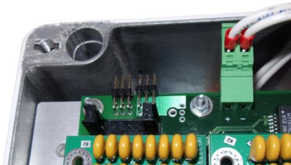
Рисунок 3.5.1 - Датчика вскрытия на плате
