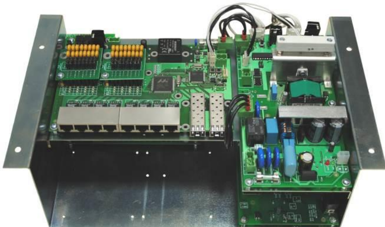
Рисунок 3.4.1 - Платы коммутатора и блоков питания
