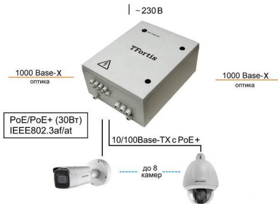
Рисунок 1 - Схема подключения PSW-2G8F+UPS-Box
