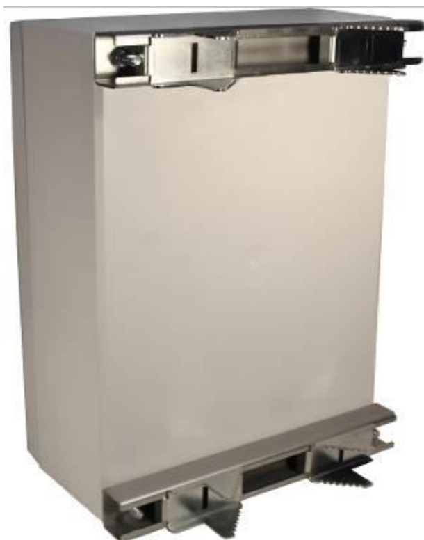
Рисунок 7.3 – Коммутатор с установленным ККС-2
