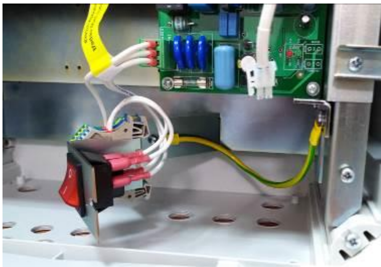
Рисунок 3.5.2 – Узел подключения питания освобожден от крепежа.
