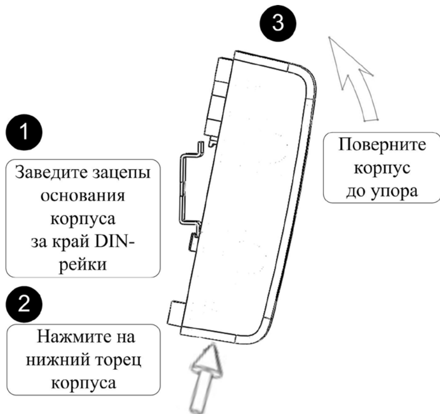
Рисунок 2.2.3 – Схема установки блока на DIN рейку.
