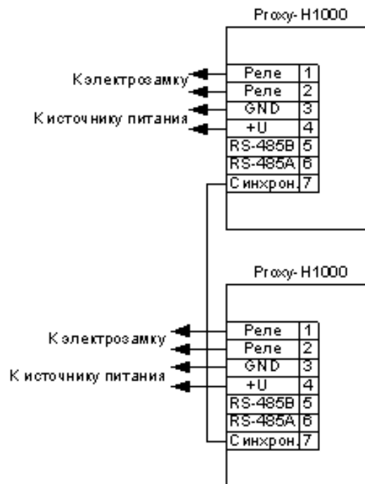
Схема соединения двух счетывателей, расположенных на расстоянии менее 30 см друг от друга
