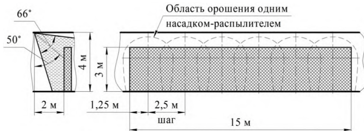
Рисунок 16 - Противопожарная защита боковой поверхности стеллажа 6-ю насадками-распылителями
