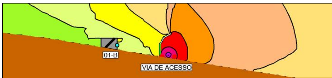
Figura 7: Mapa em corte transversal da propagação sonora da condição futura com barreira acústica.
