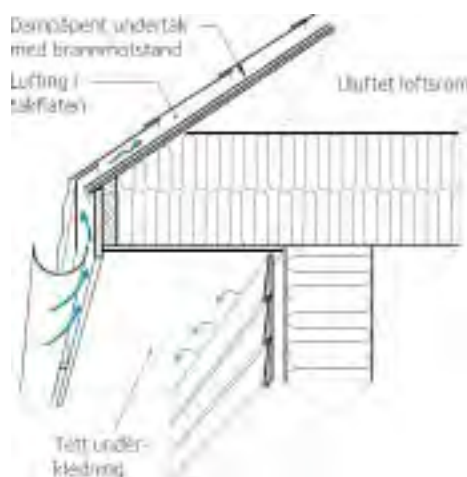
Uluftet, kaldt loft med dampåpent undertak og lufting under taktekningen
