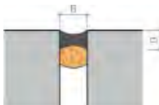
Anbefalt fugeutforming for elastisk fugemasse
