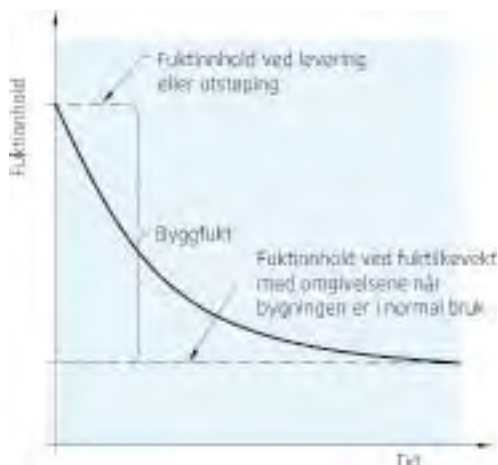
Byggfukt illustrert ved en typisk uttørkingskurve
