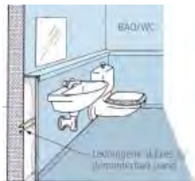
Eksempel på veggmonterte sanitærinstallasjoner med skjult rørføring
