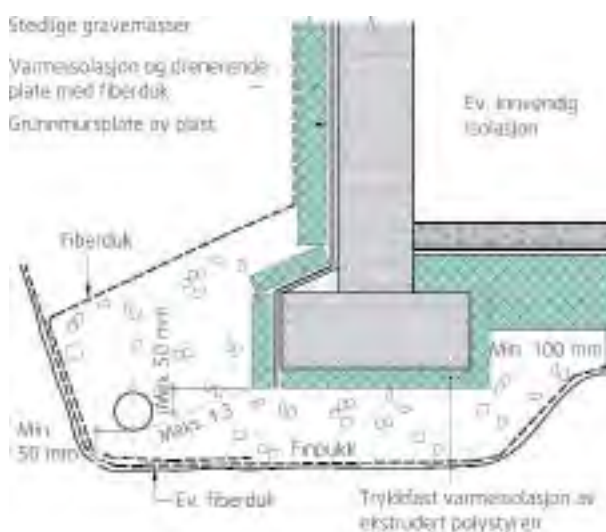
Plassering av drensledning langs fundament
