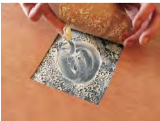
Mangelfull uttørking av et betonggolv før det limes et tett belegg kan føre til oppløsning av limet, med lukt og redusert heft som resultat. Foto: SINTEF Byggforsk
