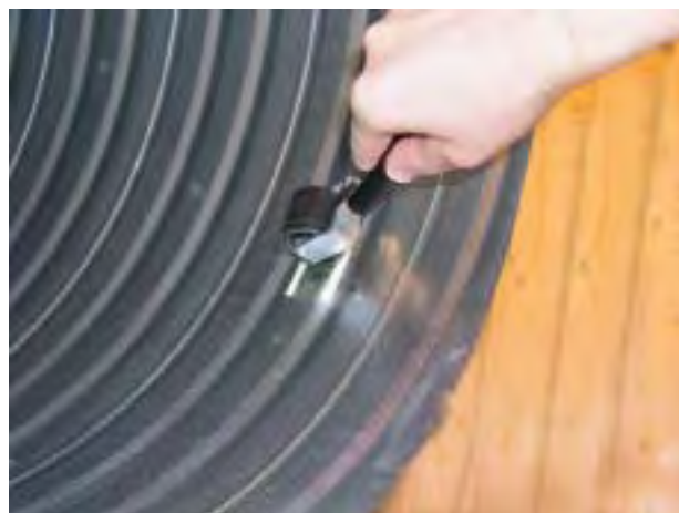
Prøvetaking med gelteip for måling av smussmengder. Prøve innhentes fra en representativ del av overflaten, for eksempel 45° opp fra bunnen av kanalen, som vist her. Foto: SINTEF Byggforsk
