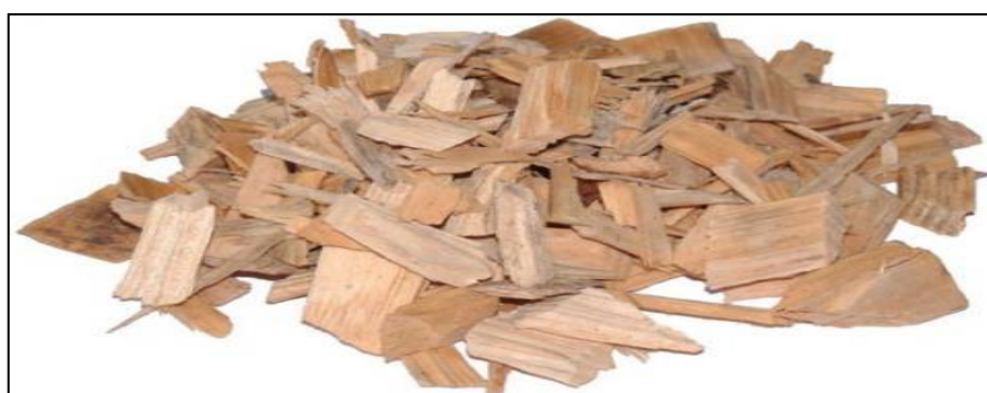
Bois déchiqueté/chips/plaquettes : présence de fines et de bois défibré.
