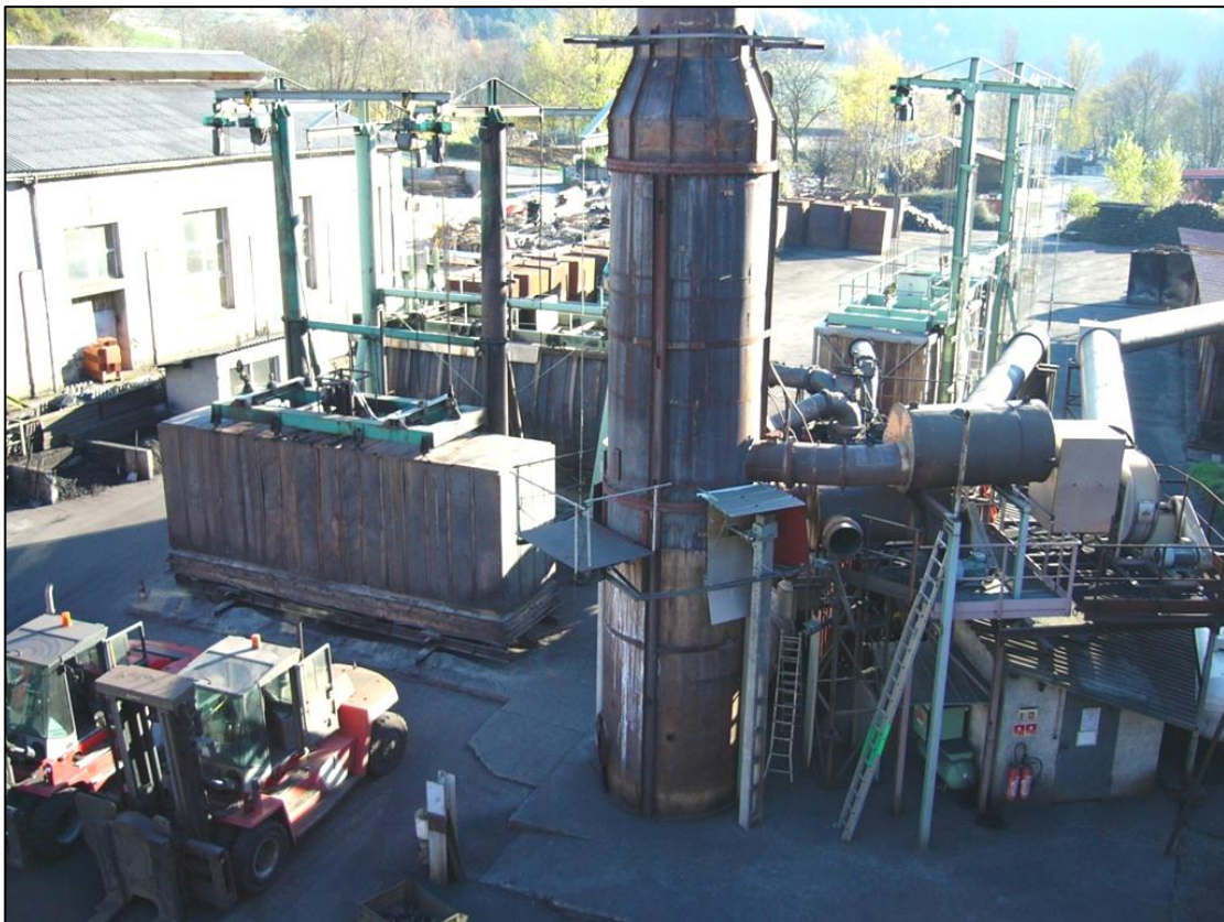
Exemple de 3 fours de carbonisation à brassage de gaz chauds, épuration des fumées, collecte des gaz chauds pour l'unité de préséchage des bois. Capacité : environ 5 500 t/an, usine certifiée ISO 14001 (management environnemental).
