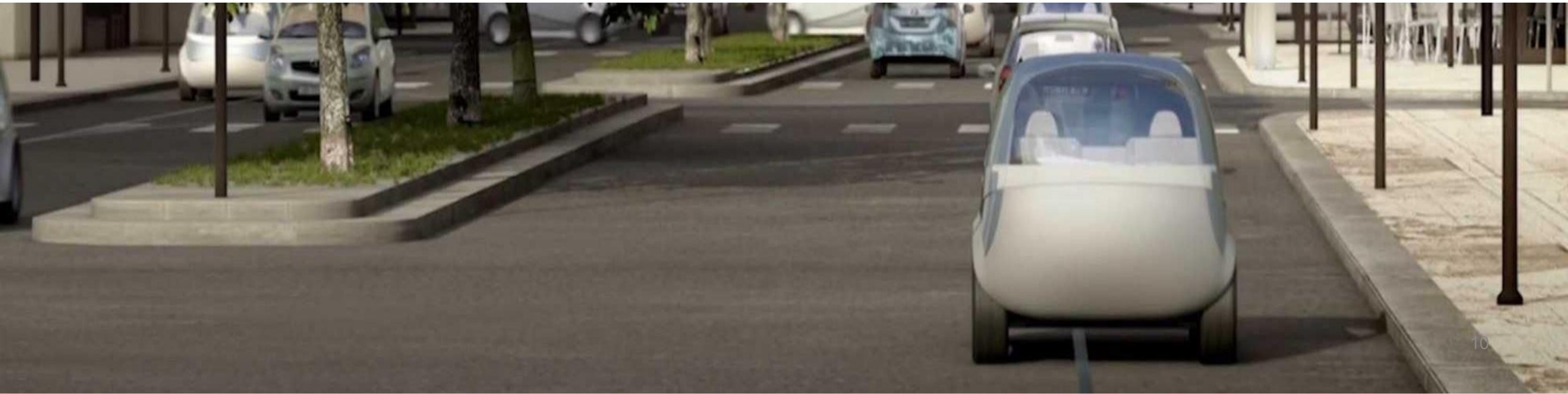
REVA2 est automatisée sur un réseau de lignes bleues et se **convertit aisément en véhicule conventionnel** par simple rotation des sièges avant, donnant accès à la conduite **manuelle** pour un usage hors du tracé de lignes bleues.
