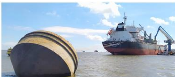
Na operação em espelho d'água as embarcações são amarradas em boias especiais posicionadas.
