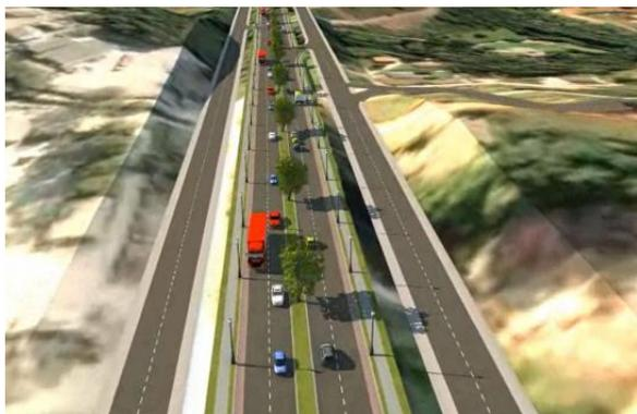
**A obra terá 8,3 quilômetros de extensão, iniciando no km 15+520 até o km 23+820. A pista central será de pavimento rígido de concreto, com placas de 25 centímetros de espessura. Foto: Reprodução/DER-PR**
