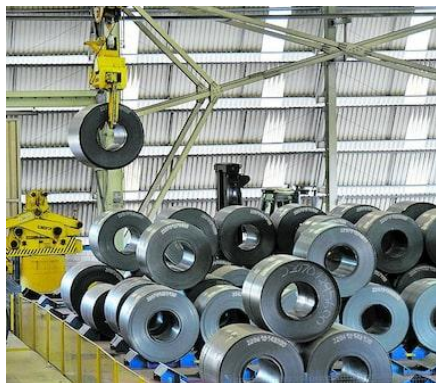
Linha de produção de bobinas de aço laminado da Gerdau na usina de Ouro Branco (MG) Foto: Washington Alves/Light Press/Estadão
