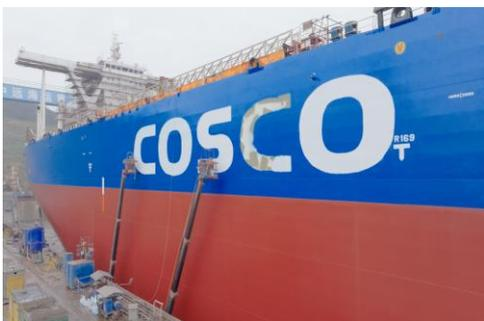
A PPG anunciou a primeira docagem a seco da Cosco Shipping Energy Transportation Ltd. utilizando sua aplicação eletrostática do revestimento anti-incrustação. O projeto foi realizado no navio petroleiro Yuan Chun Hu, de 333 metros, pertencente à Cosco Shipping, no estaleiro Liuhengdao, em Zhoushan, China. O revestimento 'PPG Sigmaglide 2390' foi aplicado no casco submerso da embarcação, enquanto outro revestimento antifouling 'PPG NEXEON 810' foi utilizado na linha d'água.
