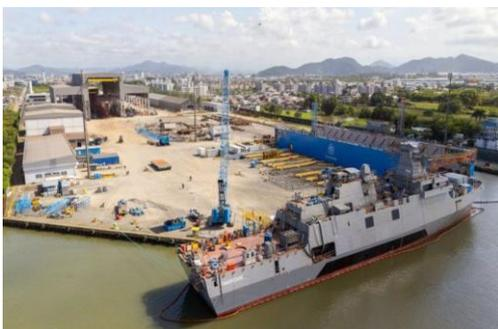
A construção das fragatas classe Tamandaré no Estaleiro Brasil Sul, da thyssenkrupp Marine Systems, conta com três fragatas em diferentes fases de desenvolvimento. A primeira embarcação, fragata Tamandaré, já foi lançada ao mar e passa pelo comissionamento dos sistemas de combate e armamentos. A segunda fragata tem o casco praticamente finalizado, enquanto a terceira avançou para a etapa de construção.
