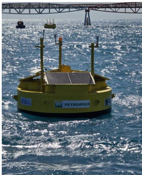
Boia Bravo, da Petrobras, para monitoramento de geração eólica offshore — Foto: Divulgação
