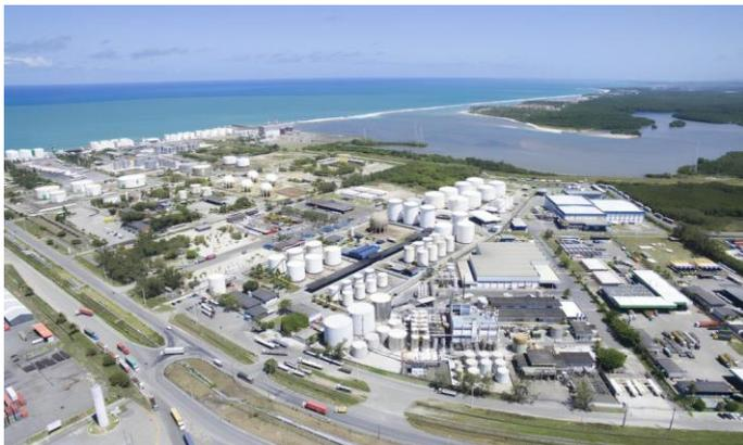
**Terminal de combustíveis da Ultracargo em Suape possui atualmente uma capacidade total de armazenagem de 157 mil metros cúbicos em 39 tanques. Foto: Ultracargo/Divulgação**
