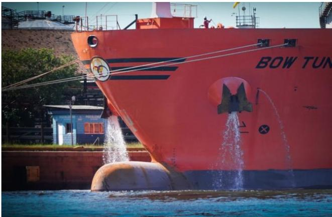
**A água de lastro refere-se à água do mar que os navios utilizam para garantir estabilidade e segurança durante a navegação, sobretudo em casos de embarcações com pouca carga**
