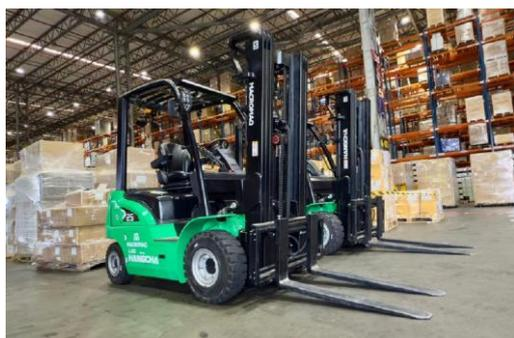
A TCP, empresa que administra o Terminal de Contêineres de Paranaguá (PR), anunciou a substituição, em agosto, de oito empilhadeiras de pequeno porte com grupos geradores a combustão por modelos elétricos com autonomia de 20 horas, tempo de recarga de aproximadamente uma hora e capacidade de carga de até cinco toneladas.
