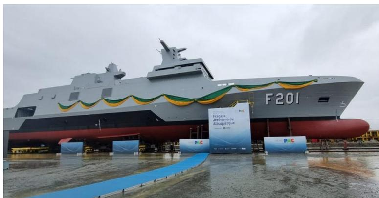
***A embarcação possui pista para aeronaves, hangar para helicópteros, radares, sensores, armamentos, velocidade máxima de 25 nós e autonomia de 5.500 milhas náuticas***
