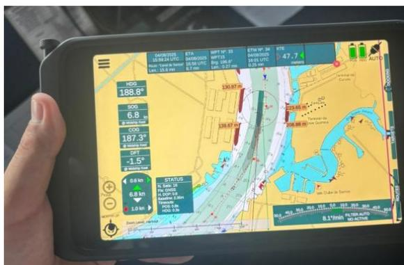
**O Portable Pilot Unit (PPU) Navigandi Orbis foi submetido a testes no Porto de Santos com o sinal de GPS desabilitado, durante manobra de saída do navio Maersk San Vincent**
