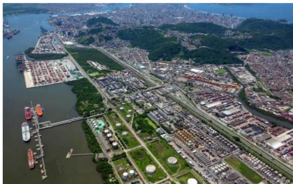
***O STS08 possui área de 152.324 metros quadrados. Estão previstos quatro novos berços e tanques de armazenagem, conexões com dutovias, rodovias e píeres na margem direita***
