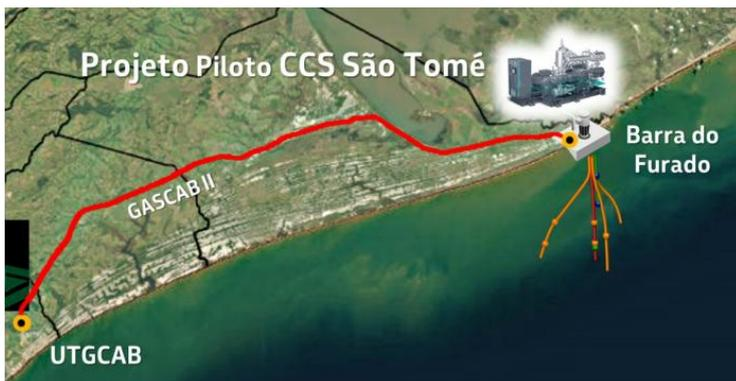
**O CCS visa capturar até 100 mil toneladas de CO<sub>2</sub> por ano, ao longo de três anos e injetá-las em um reservatório salino profundo localizado na região de Barra do Furado (RJ)**
