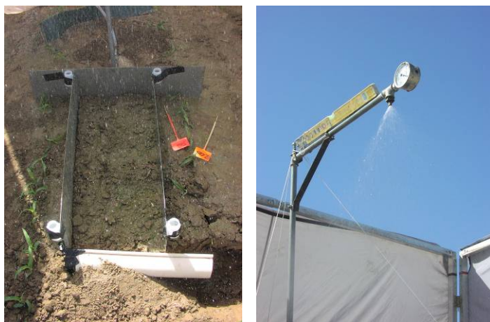
Figure 2.21- Placette de mesure du ruissellement et simulateur de pluie
